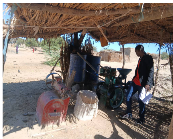
Photo 2: Une machine de transformation du mil, maïs et sorgho en farine dans le village Yarta N'gla'a dans la commune de Gueskerou
